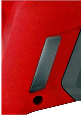
Para agregar aceite lubricante, abra el tanque quitando la tapa. Poner directamente el aceite en el tanque. Cerrar el tanque con su tapa.
